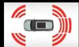
Hệ thống gồm 8 cảm biến đặt phía trước và phía sau xe giúp phát hiện và cảnh báo có vật tĩnh bằng âm thanh và đèn hiệu, hỗ trợ người lái xử lý tình huống nhanh chóng và an toàn.
